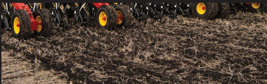
▲ Pole obsiane za pomocą niezależnego siewnika z redlicami radełkowymi Bourgault, wyposażonego w dozowniki nawozu Mid Row Bander.
